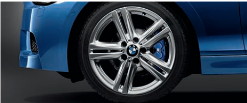
□ 18-дюймовые легкосплавные диски М-стиля Star Spoke 386 М с разноразмерными шинами, спереди 7,5 J x 18, шины 225/40 R 18, сзади 8 J x 18, шины 245/35 R 18 (предлагаются только для спортивного пакета М-стиля). □ Спортивные тормоза М, с фиксированными суппортами, спереди/сзади с окраской в темно-синий цвет, с увеличенными тормозными дисками и цветной надписью М (серийно для М135i и только для спортивного пакета М-стиля).
