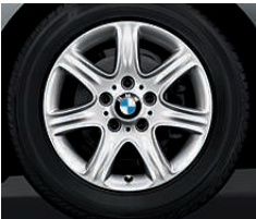
□ 16-дюймовые легкосплавные диски Star Spoke 377, 7 J x 16, шины 205/55 R 16.
