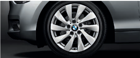
□ 17-дюймовые легкосплавные диски Turbine Styling 381, 7,5 J x 17, шины 225/45 R 17.
