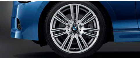
■ 17-дюймовые легкосплавные диски М-стиля Star Spoke 383 М с разноразмерными шинами, спереди 7,5 J x 17, шины 225/45 R 17, сзади 8 J x 17, шины 245/40 R 17 (предлагаются только для спортивного пакета М-стиля).
